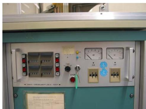
Generator und Röntgenröhre des Iso-DebyeFlex 1001 der Fa. Seifert, das zu einem hochauflösenden Laue-Diffraktometer aufgerüstet werden soll. Links: Cu-Röntgenröhre (Feinfokus 60 Cu L). Rechts: Generator, durchstimmbare in 1 kV Schritten. Standort: Mineralogisches Institut.
